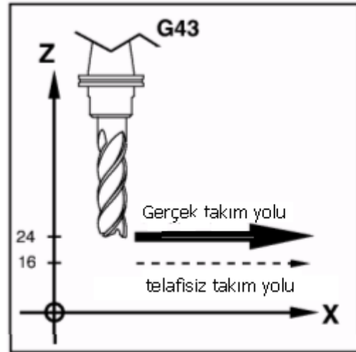
Şekil 4.30 G43 ile takım uzunluğu telifisi
