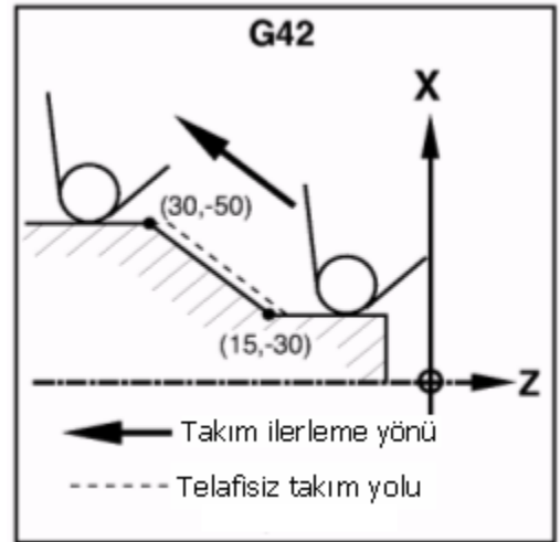
Şekil 4.44 G42 ile Takım uç yarıçapı telifisi
