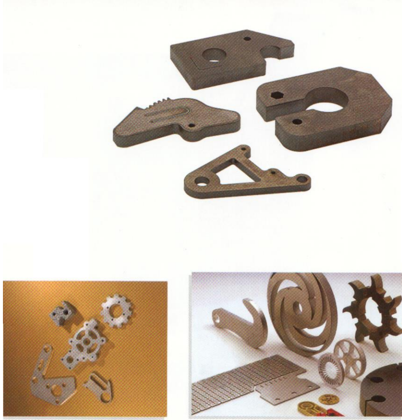
Şekil 2.29 Su jeti ve lazer ile kesme sonucu üretilen iş parçaları
