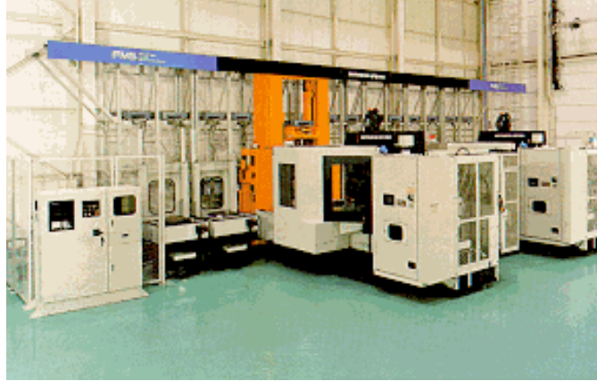
Şekil 1.3 Esnek Üretim Hücresi (FMC HG500) [16]
