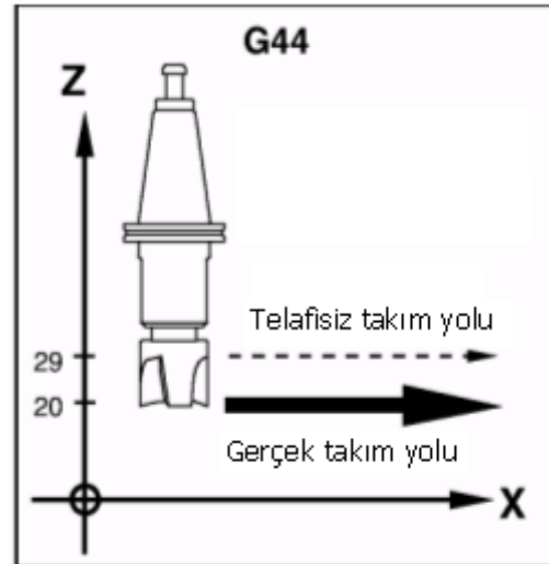
Şekil 4.31 G44 ile takım uzunluğu telifisi
